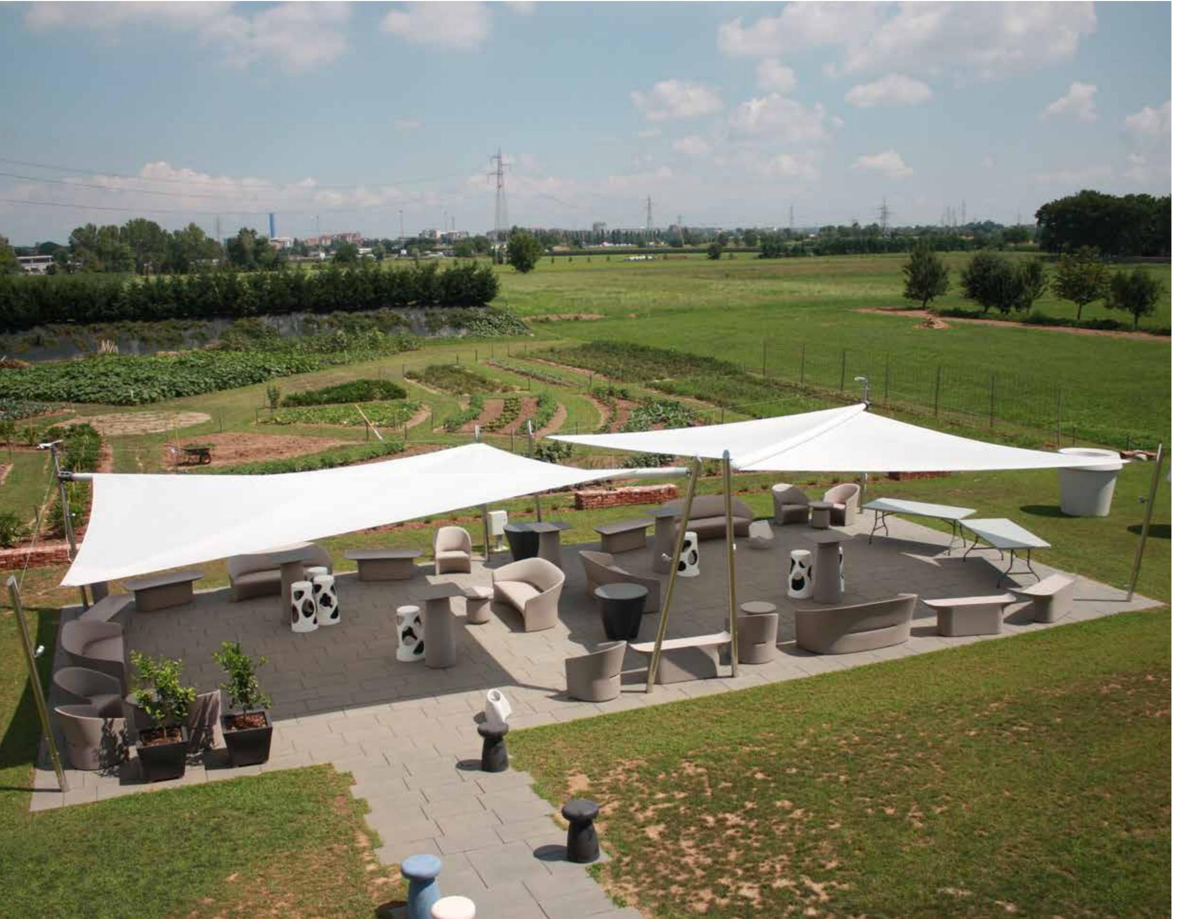
**it** I pali sono in acciaio inox elettrolucidati a specchio per garantire un'elevata resistenza alla corrosione e all'esposizione agli agenti atmosferici. Le vele, realizzate in Dacron®, si aprono e chiudono grazie alla motorizzazione posizionata all'interno del profilo avvolgitore e gestita facilmente tramite radiocomando o manualmente in caso di black-out. È disponibile anche in versione completamente manuale.
