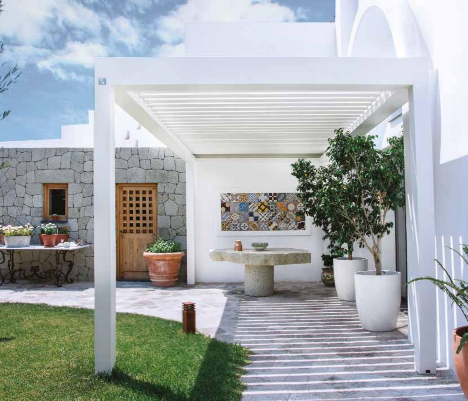
**it** Nella versione di Maestro a lamelle orientabili, il trave è alto solo 25 cm, la gronda è a filo e le dimensioni massime del modulo singolo sono 470 x 620,5 cm. Gli screen sono integrati e la pulizia delle linee estrema.
